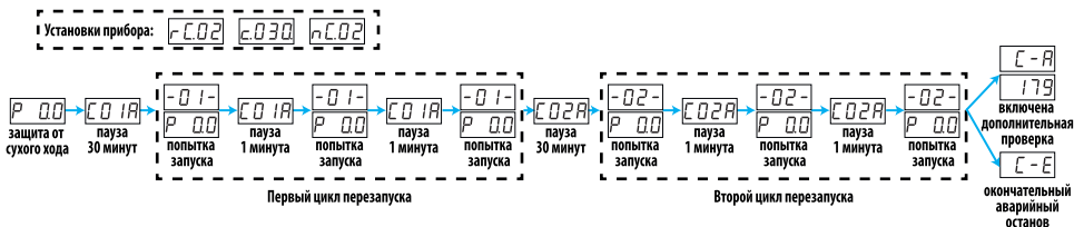
Графическое представление работы режима перезапуска “rC.02”
